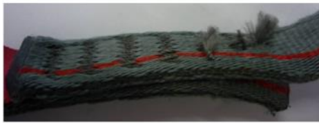
Наличие порезов или истирания сшивки
