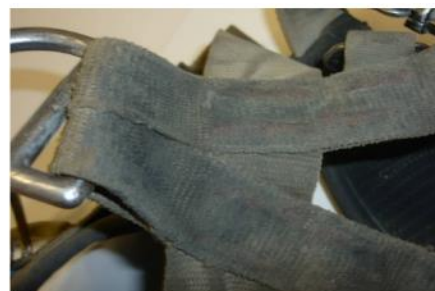
Крайняя степень износа как лент, так и сшивок
