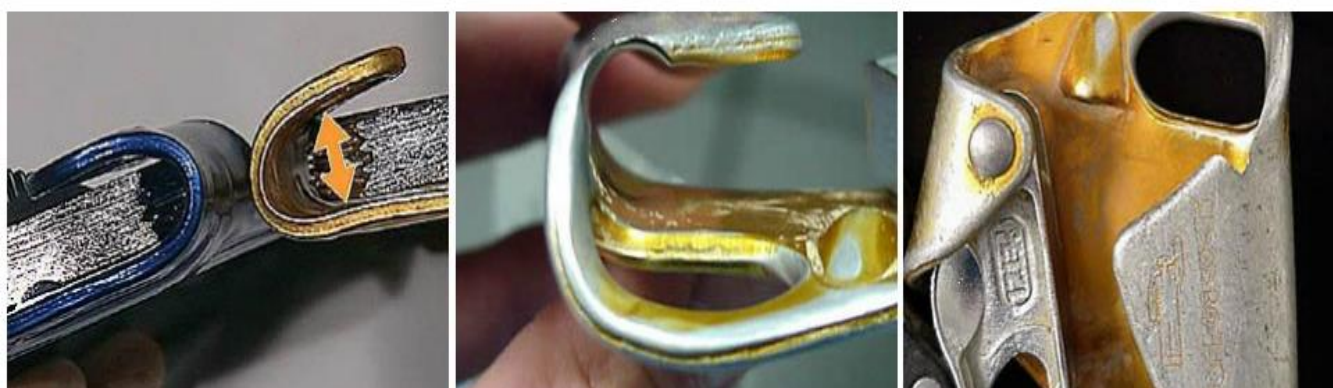
Деформация корпуса в результате приложения чрезмерной нагрузки. Сильное истирание при интенсивной эксплуатации
