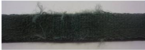
Существенный износ ленты
